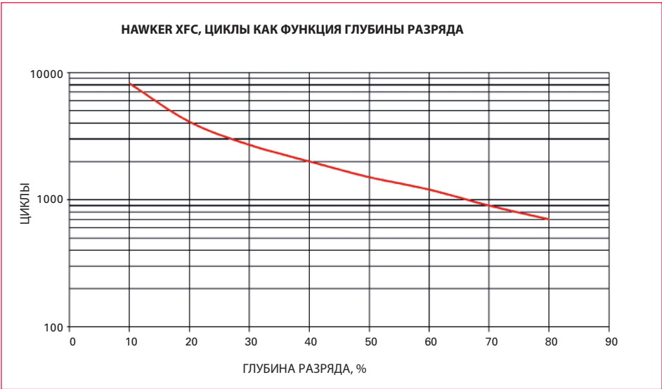
РИСУНОК 5 – РАСЧЕТНОЕ КОЛИЧЕСТВО ЦИКЛОВ КАК ФУНКЦИЯ ГЛУБИНЫ РАЗРЯДА 10-80 % (ПРИ 5-ЧАСОВОМ РЕЖИМЕ РАЗРЯДА)
